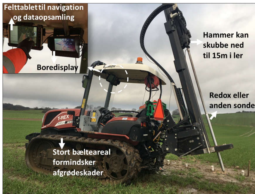
Figur 2. Billede af det udviklede boresystem med dets væsentligste karakteristika. På billedet ses også en af de piezometerreder fra T-Rex projektet
