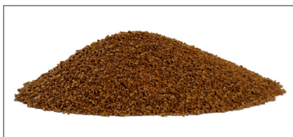
Figur 2 Jernoxidgranulat i et trykfilter er én ud af to metoder anvendt til fjernelse af arsen i Danmark.
