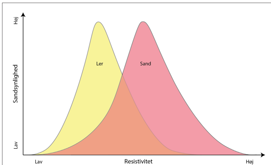
Figur 3. Skitse af statistisk forhold mellem litologi og resistivitet.
