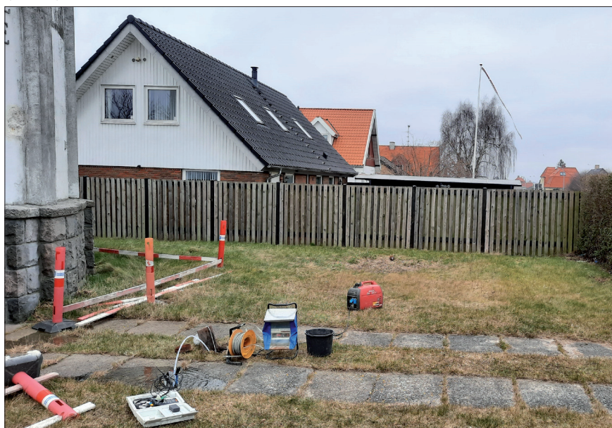
Figur 5. Foto af prøvetagning i den boring, som gav den højeste DMS-koncentration (0,33 µg/L, filter placeret 4-9 meter under vandspejlet). Denne boring er central placeret i det største og mest homogene villa-område i Hvidovre
