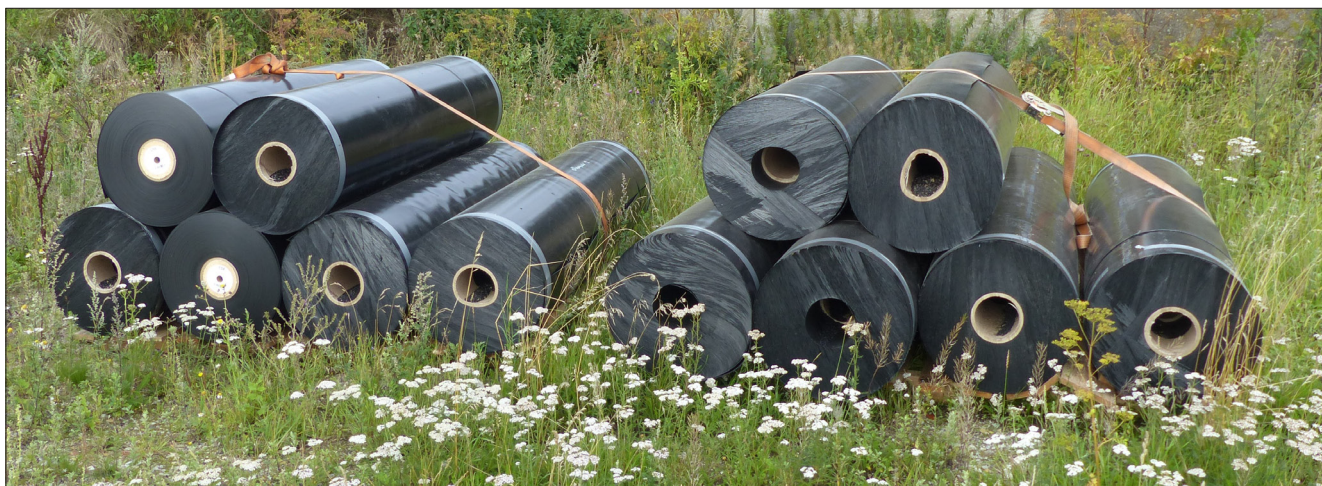
Foto 1: HDPE plastmembraner 1,5 mm leveret i ruller af 1,4-2,5 meters højde (Foto: NaturRådgivningen A/S)
