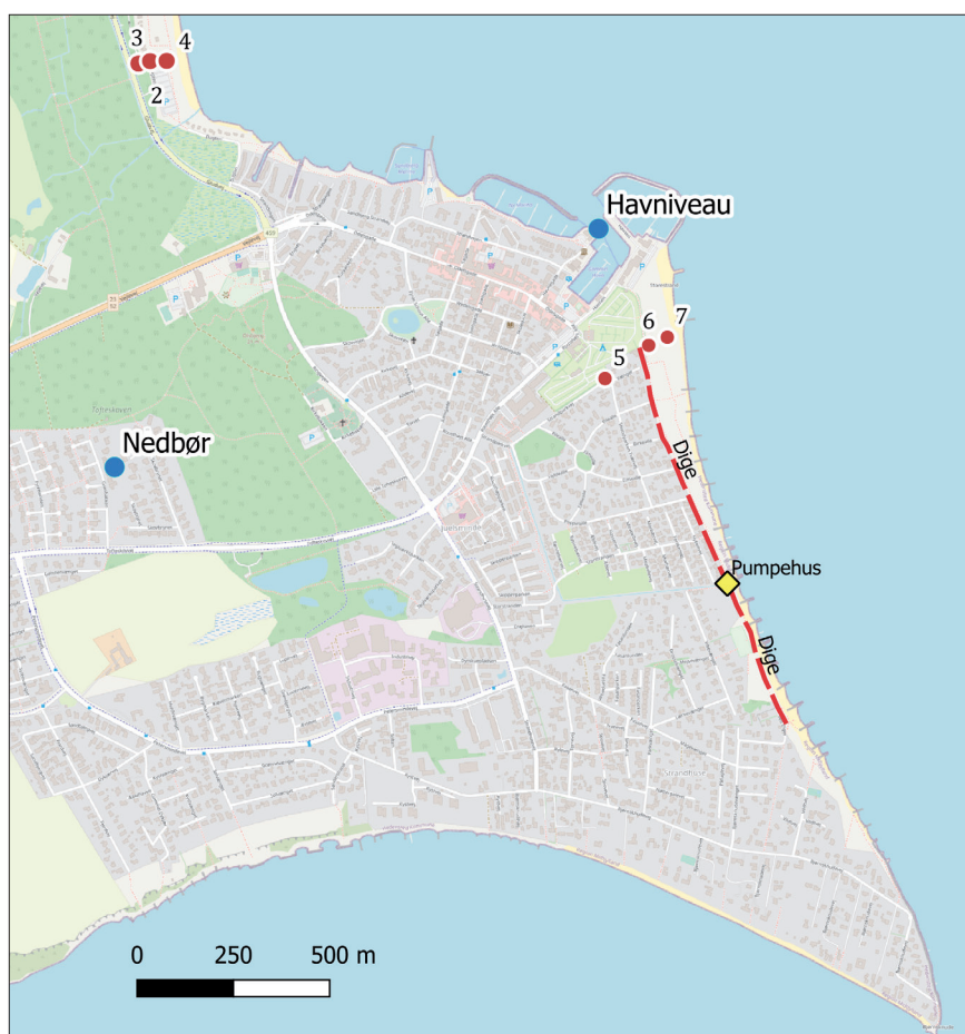
Figur 1: Kort over Juelsminde. Røde prikker viser loggerpositioner. Blå prikker viser positioner af hhv. havniveaulogger og nedbørssensor. Rød stiplede linje viser beliggenheden af diget, med pumpehuset markeret med gul firkant hvor vandet pumpes fra et drænende vandløb ud i havet.
