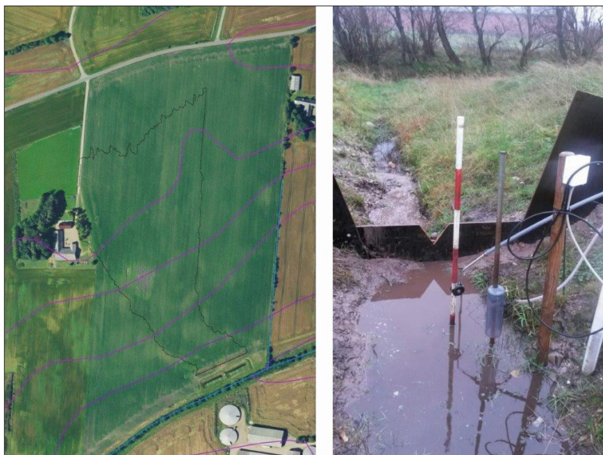
Figur 1: Afgrænsning af område fra mark med overfladisk afstrømning og installation af V-overfald med måling af vandstand og udtag af vandprøver med automatisk start af ISCO-prøvetager lige før vandløbet, som ligger langs træerne bag ved V-overfaldet. I foto'et til venstre ses en etableret intelligent randzone (IBZ), som to aflange damme i kanten af marken. Overfladeafstrømningen fra marken løber langs IBZ'en til erosionsgrøften og V-overfaldet.
