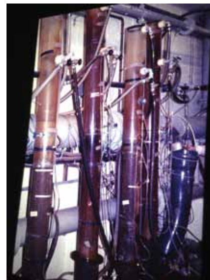
Figur 1b. En serie forsøgsfiltre på Robbedale Vandværk.
