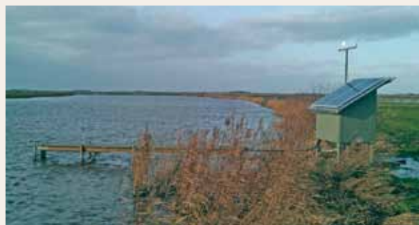
Fig. 2. Et eksempel på tværsnitprofilens udseende den 2. januar 2012. Bundprofil og vandhastigheder er målt med et ADCP-instrument. Placeringen af måleudstyret er markeret sammen med en skematisk tegning af strålespredningen fra Doppler sensorerne. På billedet ses målebroen og huset til prøvetagere, datalogger og solceller placeret ved vandløbets højre bred.
