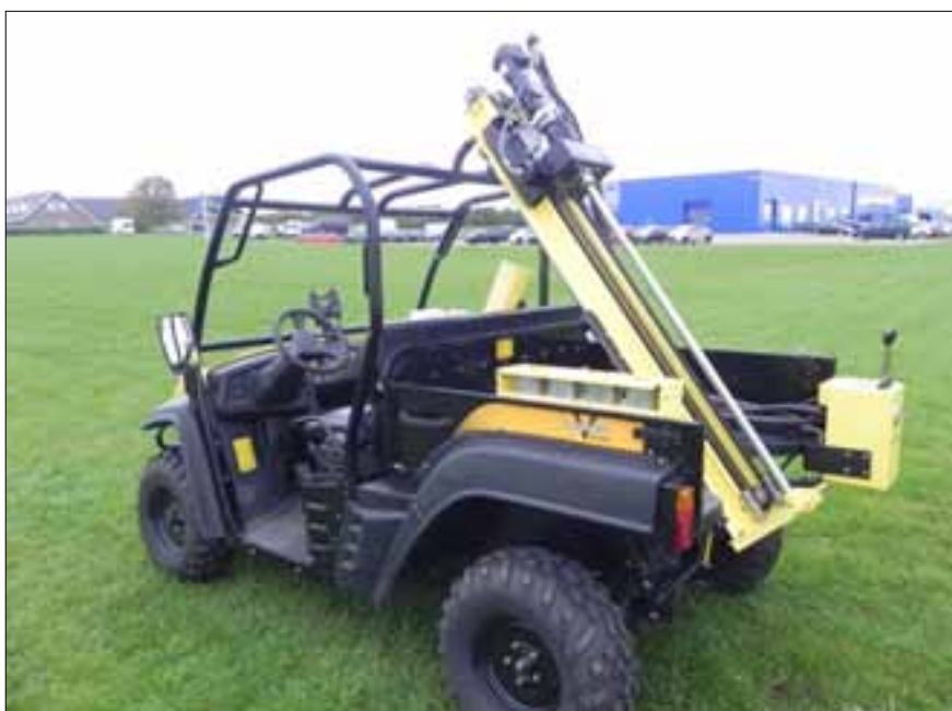
Foto 1. Prøvetagningsudstyret kan f. eks. være monteret på en Gator.
