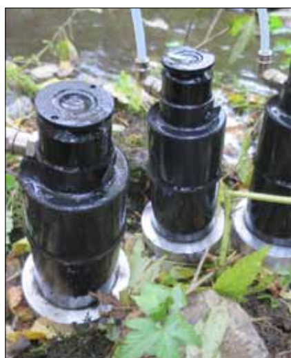
Figur 2. SorbiCeller med monteringer klar til placering i vandløb (venstre) og billede af systemet fastgjort til nedrammet pæl (højre).
