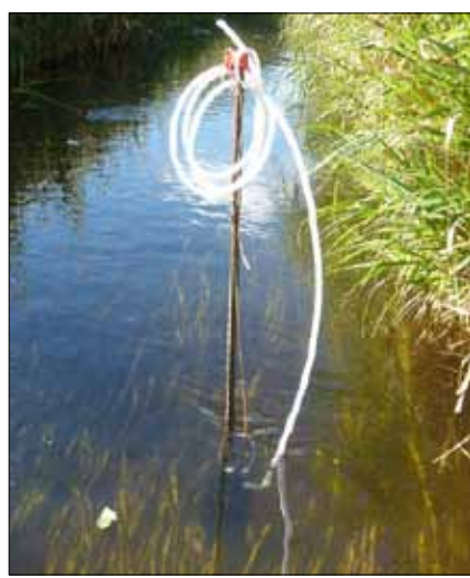
Figur 2. SorbiCeller med monteringer klar til placering i vandløb (venstre) og billede af systemet fastgjort til nedrammet pæl (højre).
