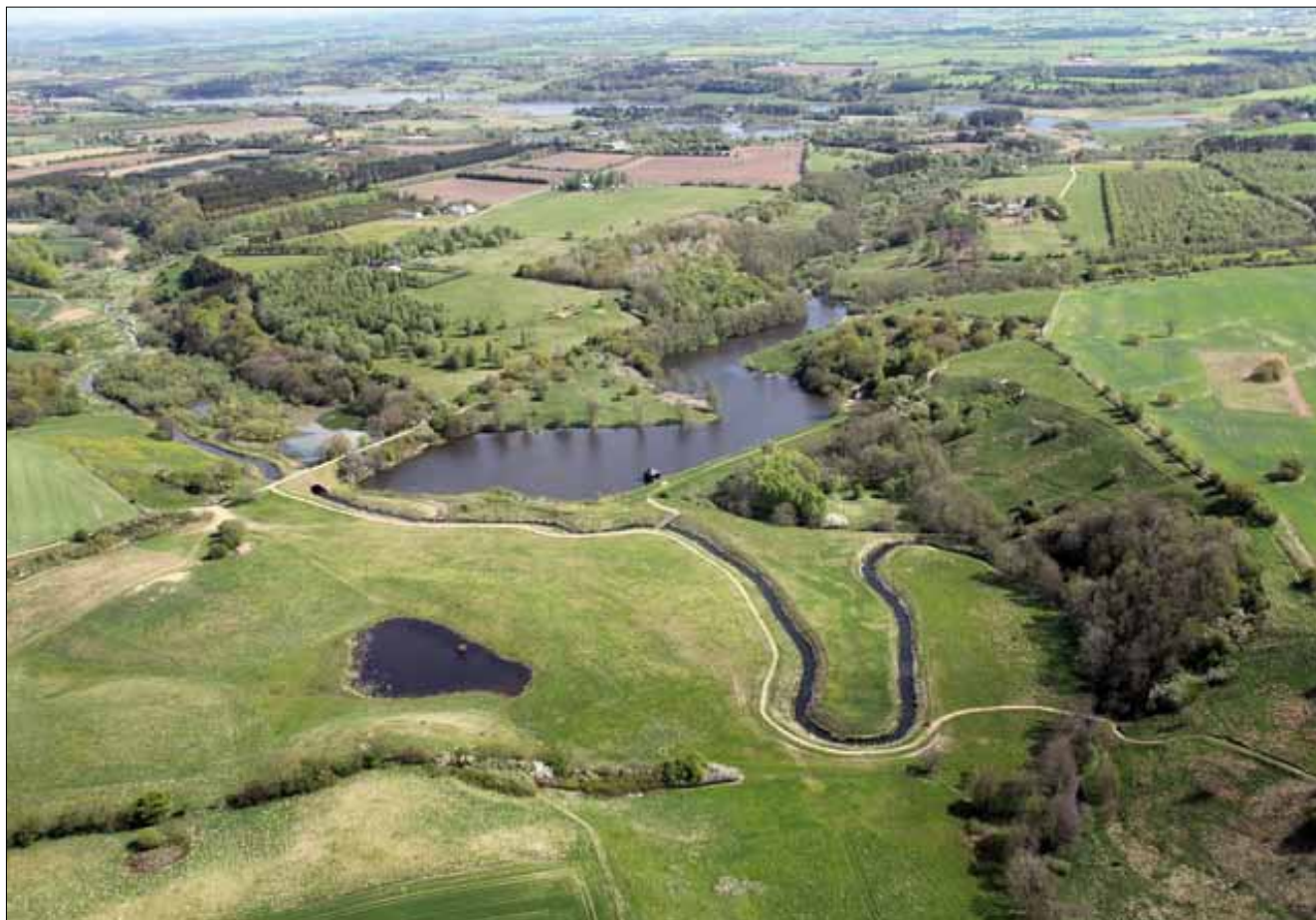
Figur 1: Ferup Sø blev i 1920 etableret for at Vester Nebel Å kunne levere vand til vandkraftværket ved Harte. I 2008 blev der etableret et ca. 1000 m langt stryg, der fører alt vandet i Vester Nebel Å udenom Ferup Sø. Derved blev der skabt fri passage til ca. 40 km vandløb ovenfor søen. Foto: Sten Bøgild Frandsen.
