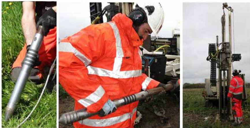
Figur 2. Til venstre et nærbillede af den nyudviklede Ejlskov-redoxprobe, i midten monteres redoxproben på boreudstyret og til højre trykkes eller bankes redoxproben ned i jordlagene. Tæt ved boringen anbringes referenceelektroden umiddelbart under jordoverfladen i et hul med en opslæmning af jord og vand.
