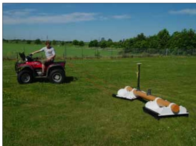
Figur 1. Den anvendte georadar (venstre, foto: Rambøll Danmark) og det anvendte elektromagnetiske induktionsinstrument (højre, foto: Mogens H. Greve). Begge instrumenter trækkes af en ATV (All-Terrain Vehicle).
