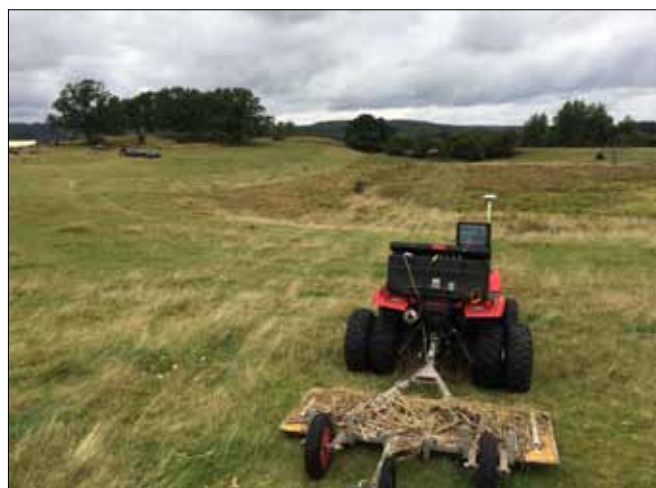
Figur 1. Den anvendte georadar (venstre, foto: Rambøll Danmark) og det anvendte elektromagnetiske induktionsinstrument (højre, foto: Mogens H. Greve). Begge instrumenter trækkes af en ATV (All-Terrain Vehicle).
