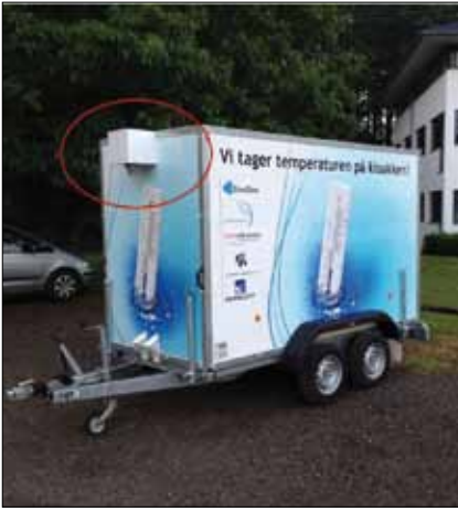
Figur 2. Trailer med DTS-computer, dataopsamlings- og kommunikationsudstyr, nedbørsmåler (rød cirkel) mv.
