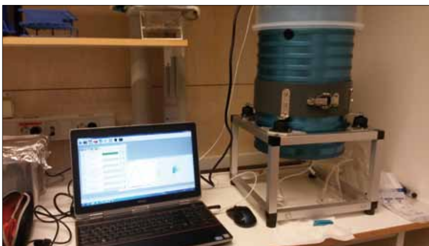
Figur 1: Pulse-shape recording FlowCytometer (PFCM) fra CytoSense, som er anvendt i denne artikel.
