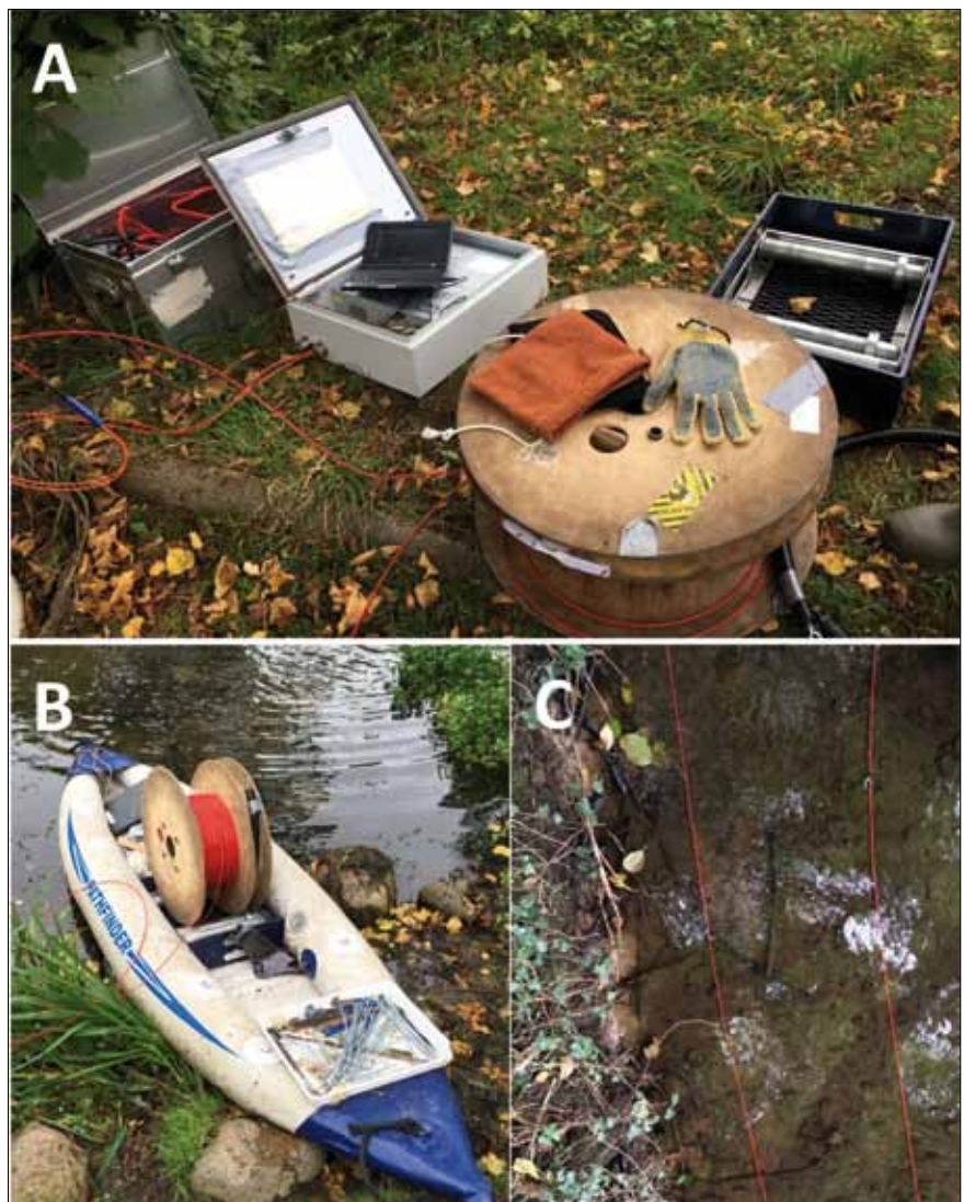
Figur 3. (A) DTS-metoden består af et fiber optisk kabel (rødt kabel på tromle), et DTS-system med laser og computer (åben, grå boks), samt strømforsyning (bilbatterier i aluminiumskassen). (B) Udlæg af kablet i overfladevand gøres lettest, hvis kablet kan transporteres i en båd. (C) Eksempel på udlæg af fiber optisk kabel langs bunden af vandløbet.
