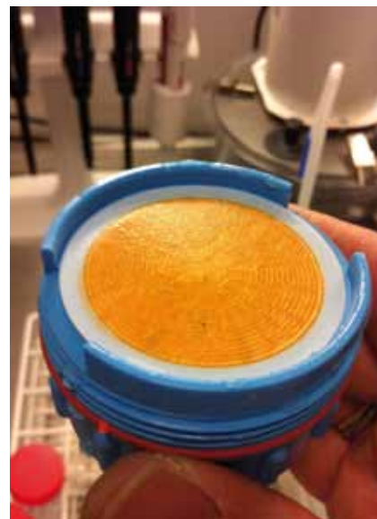
Figur 1: Billedet til venstre viser en Dead-End filtrering foretaget direkte på tappehanen ved et vandværk. Værkets vandtryk bruges til at presse vandet gennem filteret. Billedet til højre viser de bakterier og partikler der er tilbageholdt på filteret.
