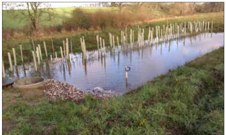
Figur 2. Koncepter for instrumentering og måling i en intelligent bufferzone – som ved det eksperimentelle IBZ anlæg ved Fillerup. Der måles i flow i indløb og afløb med flowmètre, udtages vandprøver og måles vandstand i den åbne, dybe del af bassinet (grøften) og er opsat transekter af piezometre til måling af grundvandsstand og udtag af vandprøver i infiltrationszonen af anlægget.
