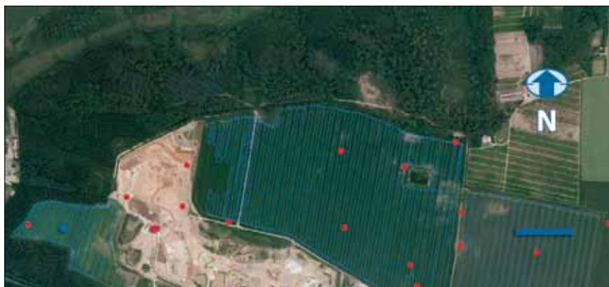
Figur 2. Oversigtskort over Kalbygård-kortlægningen. De blå prikker/linjer er geofysiske modeller, og de røde cirkler borer.
