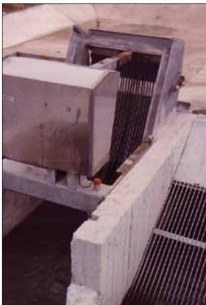
Foto 1: Riste skal fjerne større emner fra spildevandet inden det løber ind i rensningsanlægget. Riste har en stangafstand på 1-10 cm. Jo tættere rist desto større ristestofmængde opsamles. Her ses en rist på rensningsanlægget i Karditsa, Grækenland. (Foto: Aquafoto, Grækenland)
