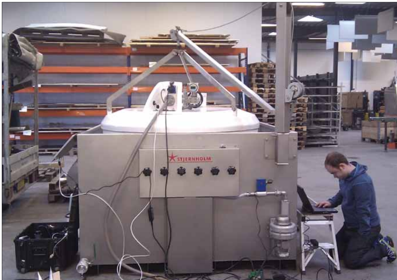
Figur 2. Test af nyudviklet transportabel offgas-måler
