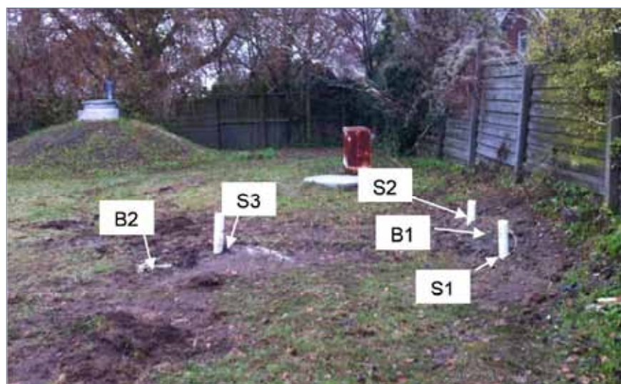
Figur 3. Oversigtsbillede med placering af kerneboringer og sugeceller i området med det tidligere konstaterede hot-spot /4/.
