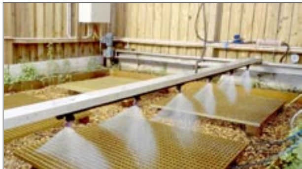
Figur 5. Sprinklersystem over forsøgsblokken, hvor pesticid og andre sporstoffer tilsættes (fra 18).
