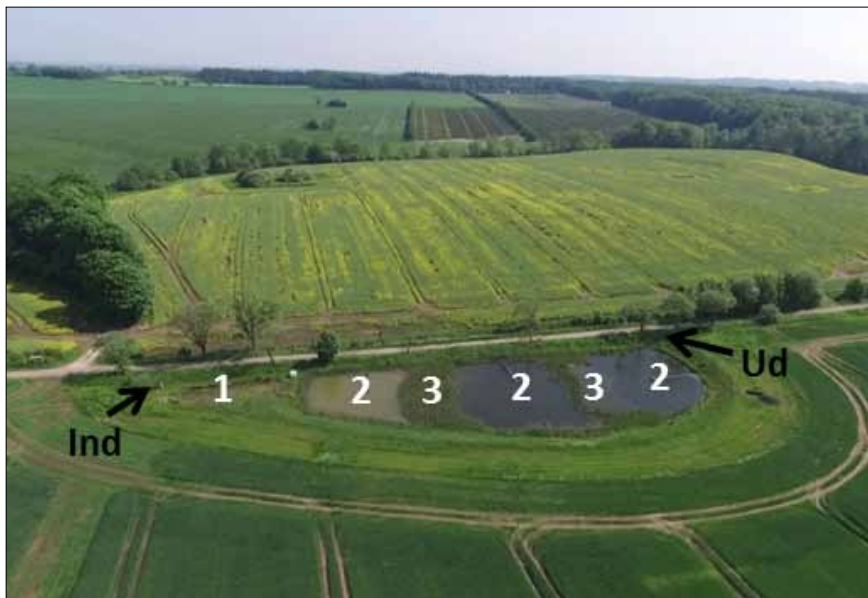
Figur 2. Minivådområdet ved Fillerup med indløb, sedimentationsbassin (1) dybe åbne zoner (2), lavvandede vegetationszoner (3) og udløb. Dronefoto: SEGES.
