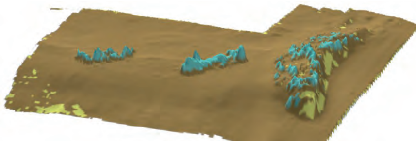
Figur 2. Revstrukturer fra de udlagte sten (de blå partier) (figur 2, fra ref. /1) af det genoprettede stenrev. Revene udgør knap 30.000 m 2 af projektområdet. Der er etableret en række nye revstrukturer med bl.a. huledannende stenrev, ligesom det eksisterende (østlige) stenrev er stabiliseret. Der blev foretaget to opmålinger af området i hhv. 2009 og 2012 som viser at de udlagte sten ligger stabilt.
