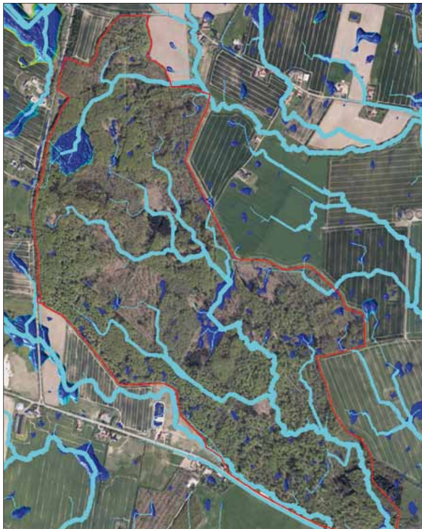
Figur 2: Kortet viser simulering af afstrømningsforhold, vandføring i grøfter/vandløb, samt hvor der vil stå vand på terrænet ved store nedbørshændelser. Kortet er fra Roden Skov i Sønderjylland.
